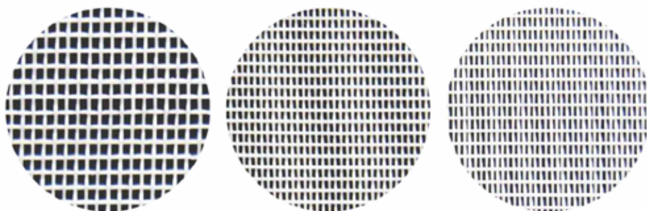
Figura 44. Tela lateral do tipo clarite (esquerda), tipo citrus (centro) e anti-inseto (direita) para revestimento lateral e frontal dos abrigos de cultivo
